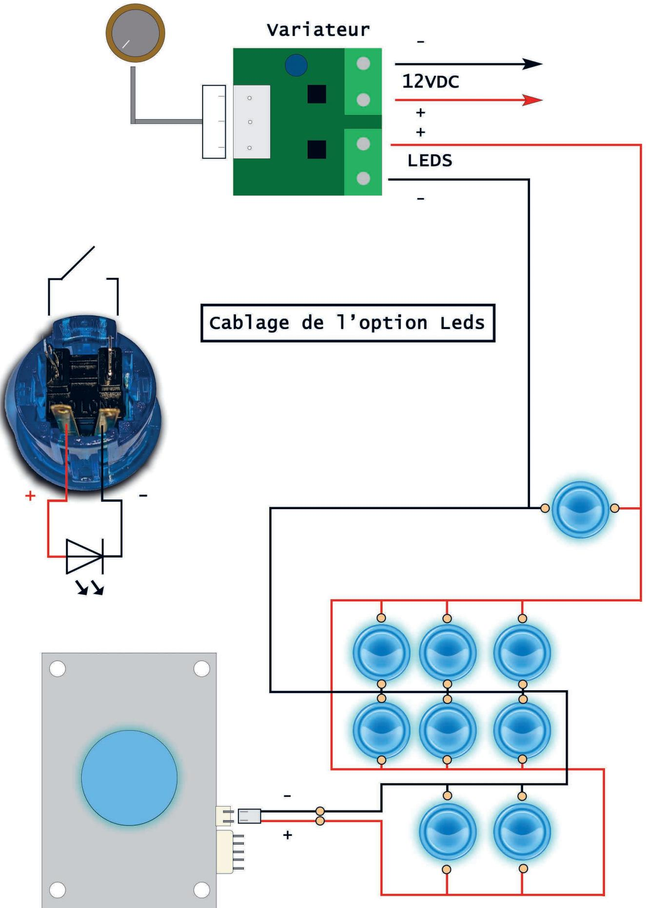
cablage de l'option Leds
